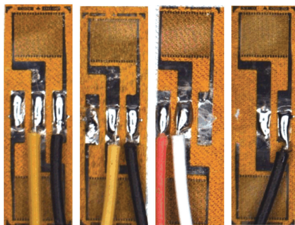
(a) 焊锡正常 (b) 少焊 (c) 焊锡脱落 (d) 焊盘脱落
