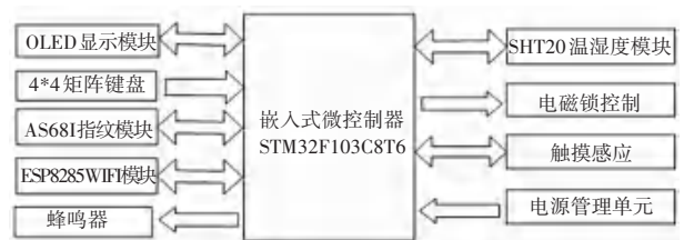
图 1 门禁终端系统框图
