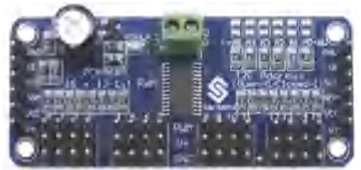
图6 PCA9686 舵机控制电路板
